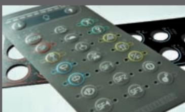
Tastaturfolie mit Prägung ermöglicht eine spürbar bessere taktile Rückmeldung.
